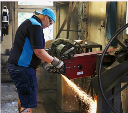
Fernanda Gianì bereitet die Hufeisen an der Bandschleifmaschine vor.
